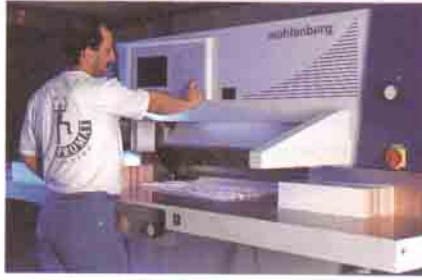
Bilim ve Teknik'in matbaa öyküsü: 1) Film aşaması, 2) Ozalit ya da prova baskı için hazırlık, 3) Kalıp hazırlama ünitesi, 4) Baskı aşaması, 5) Kırım makinesi ile katlama işlemi, 6) Harmanlama ve kapakların takılması, 7) Derginin boyutlarına göre kesilmesi, 8) Poşet ve paketlenme.
