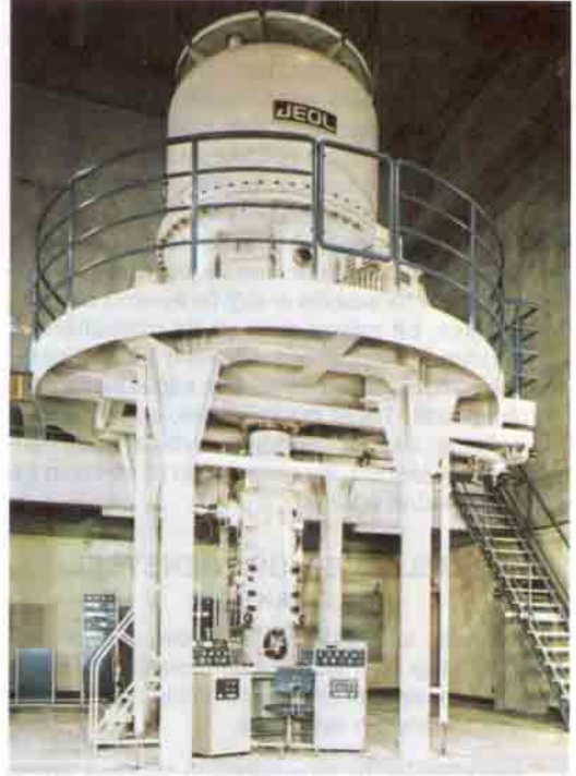
1000 kilovoltluk JEM-1000/1250 yüksek voltaj geçirmeli elektron mikroskobu.
