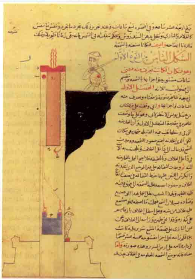
Otomatik kuş ve otomatik adamın karşıtlıklı etkilerle birbirlerinin hareketlerini ayarlaması.
