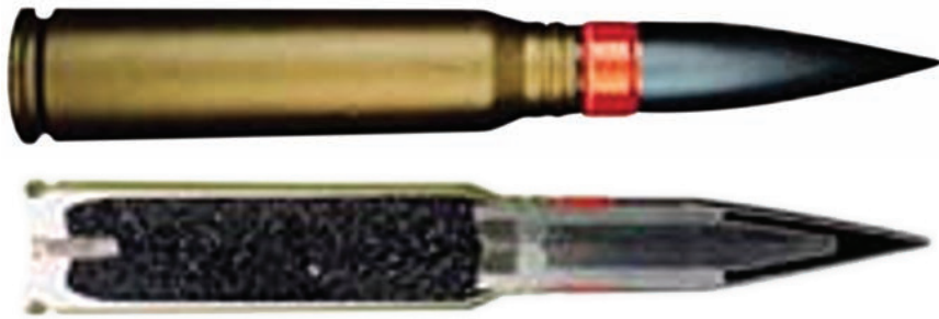
GAU-8, PGU-14/B tipindeki uranyum mermisinin kesiti ve iç yapısı. Merminin, sonundaki ateşleyici bölümüyle birlikte toplam uzunluğu 29 cm ve toplam kütlesi 690 gram. Uranyum çekirdeği merminin ön bölümünde 14,5 cm uzunluğunda olup 270 gram. Merminin hızı saniyede 1 km kadar (saate 3640 km)
