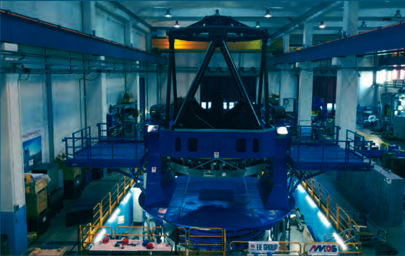
Doğu Anadolu Gözlemevi'ne kurulacak olan 4 m çaplı teleskop
