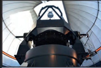
Çanakkale Onsekiz Mart Üniversitesi Ulupınar Gözlemevi'ndeki 122 cm çaplı teleskop
