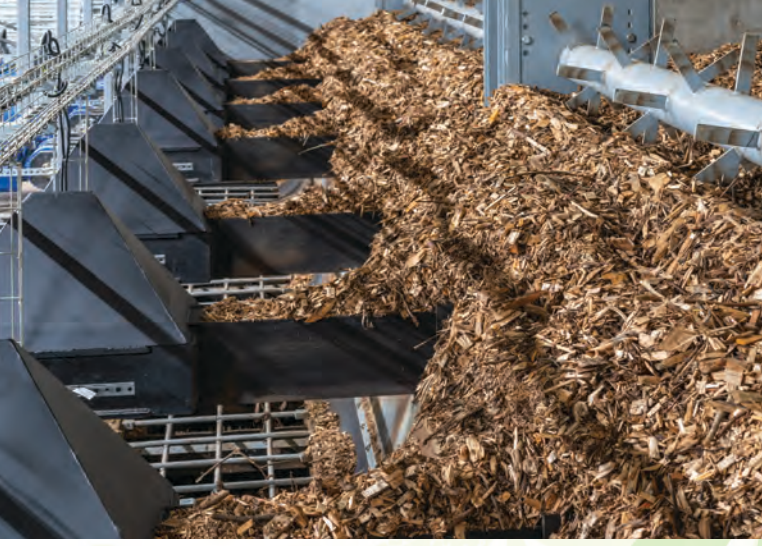
Biyoyakıt üretimi sürecinde ağaç parçalarının taşınması süreci
