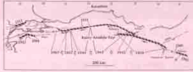
Şekil 2: 1939-1967 yılları arasında batıya sırayla göç eden büyük depremlerin meydana getirdiği yüzey kırıklarının uzanımı. Bu yüzey kırıkları boyunca meydana gelen yer değiştirme miktarları bazı yerlerde 7-7.5 metreye erişmektedir.
