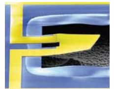
Denyede kullanılan 40 mikron uzunluğundaki diyapazonun taramalı elektron mikroskobu altında görünüşü
