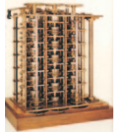
Fonksiyonların hesaplanması için tasarlanmış Fark Makinesi
