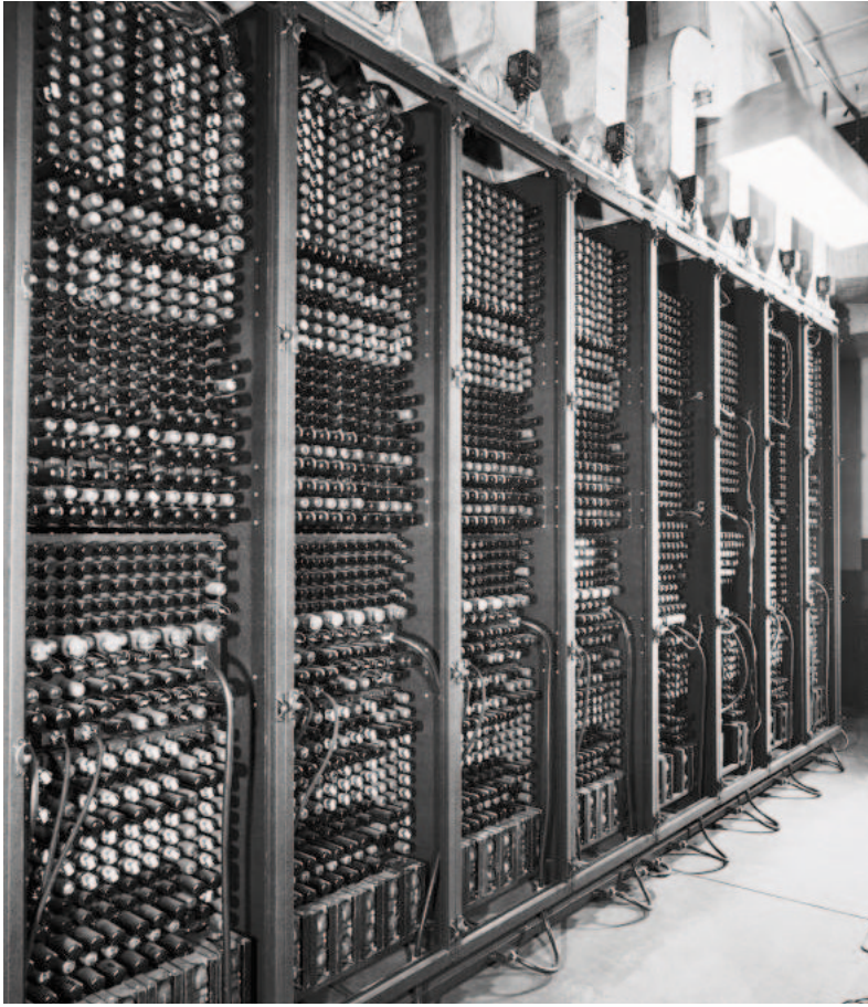
Vakum Lambaları: ENIAC'da 18.000 vakum lambası bulunuyordu.
