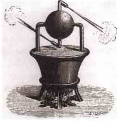
Hero'nun dönen küresi hem buharlı makineye, hem de jet teknolojisine fikir babalığı yapmıştır.
