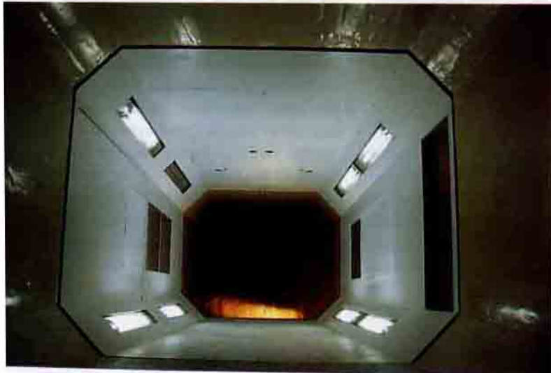
Ankara Rüzgar Tüneli (ART) deney odası. Akıma ters yönde, çıkış dağıtıcısından daralma konisi başlangıcındaki üçüncü perdeye doğru bakış
