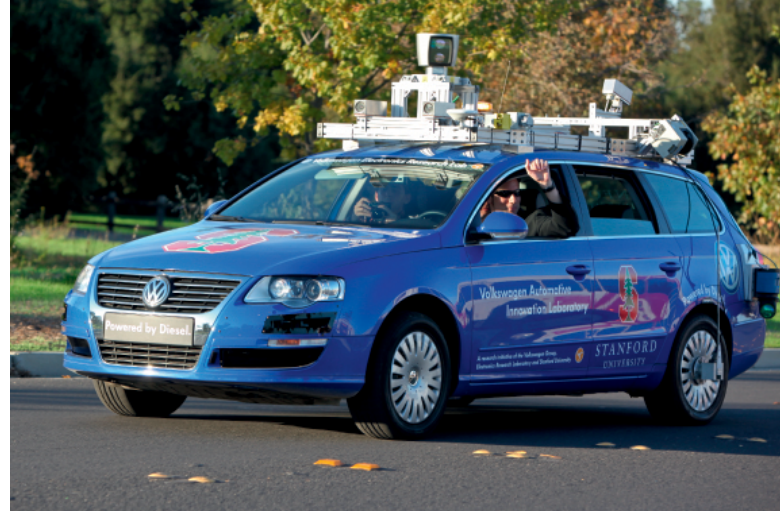
Silikon Vadisi'ndeki Stanford Yapay Zekâ Laboratuvarı ile Volkswagen Elektronik Araştırma Laboratuvarı geleceğin sürücüsüz otomobillerini ortaklaşa geliştiriyor.
