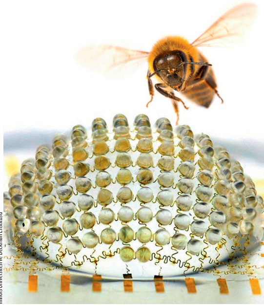
Yaklaşık olarak bir yarıküreyi kaplayan toplam 180 yapay ommatidiumdan oluşan yapay böcek gözü kamera
