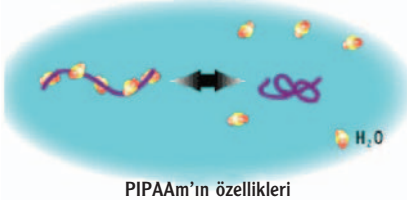
Sulu çözelti içerisinde PIPAAm’in sıcaklıkla çözünürlük/çözünmezlik değişimi
