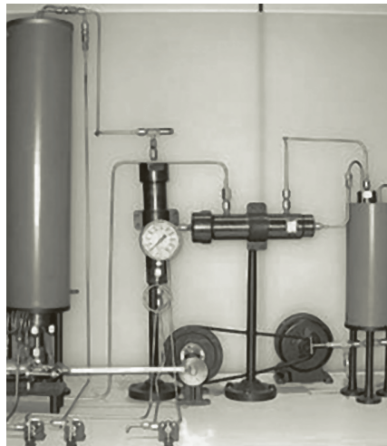
F. Haber'in amonyak sentezini başardığı ilk deney düzeneği (Alman Müzesi, Münih)
