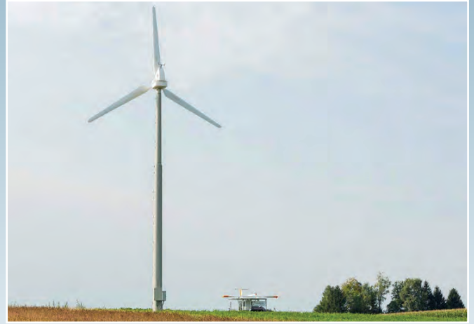
TwingTec firması tarafından üretilen bu HKRES yanında durduğu rüzgâr türbiniyle hemen hemen aynı gücü üretiyor.
