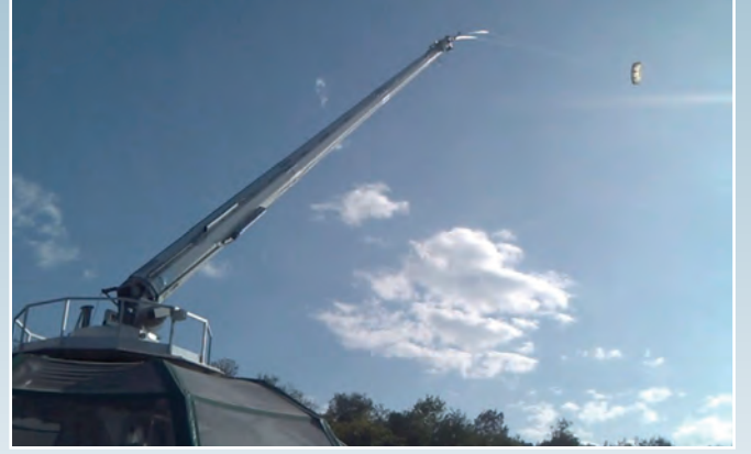
KiteGen firması tarafından tasarlanıp üretilmiş bir HKRES
