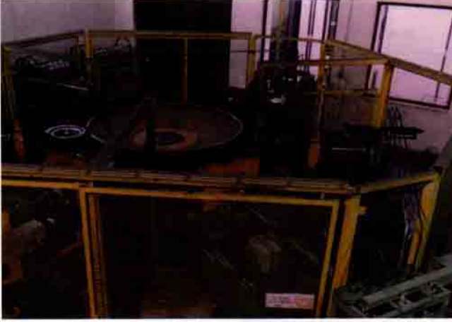
Lastik kontrol makinesinde dayanıklılık, denge ve düzgünlük gibi çeşitli testler yapılarak kalite kontrolü yapılıyor.
