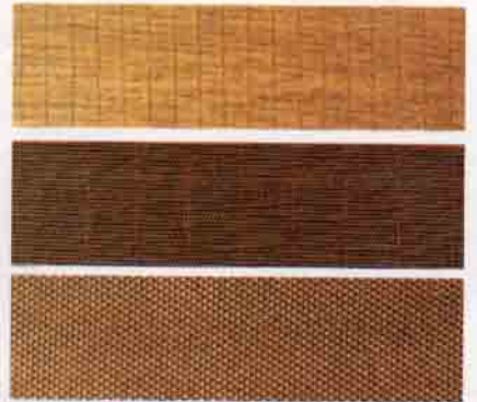
Lastik üretiminde kullanılan organik elyaftan üretilmiş kord bezleri ve bir lastiğin iç kesiti görülmüyor.
