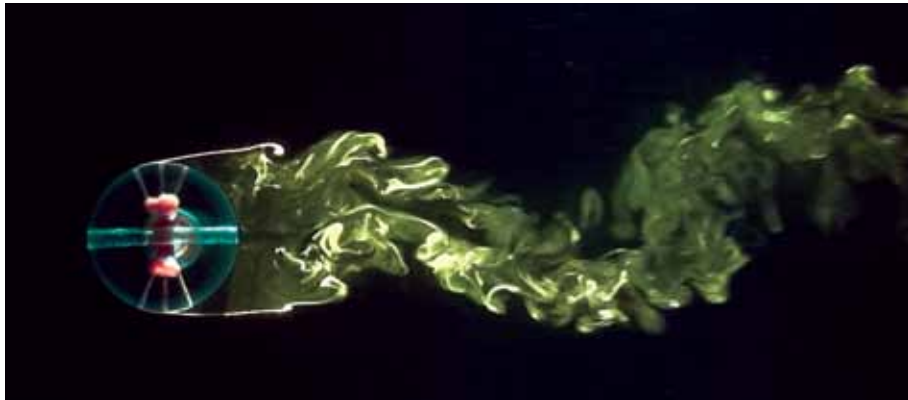
Akış içerisine yerleştirilmiş küresel bir cismin arkasında oluşan Karman girdap caddelerinin boya ile görünür hale getirilmiş şekli (Ozgooren ve ark. 2011a).
