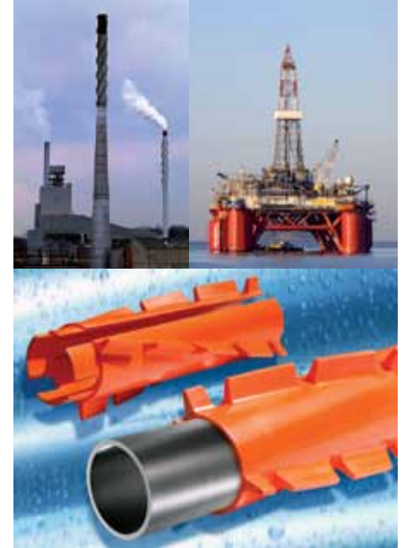
Silindirik yapıdaki bacalarda rüzgârdan kaynaklanan dinamik yüklemelerin engellenmesi için bacaların etrafına sarılan helisel yapılar (solda). Petrol arama platformlarının gövdesinde (sağ üst) ve su altı boru sistemlerinde (sağ alt) dalgalardan ve sualtı akıntılardan kaynaklanan dinamik yüklemeleri önlemek için helisel yapılar kullanılır. Petrol arama platformlarının ardında oluşacak Karman girdapları sızıntı durumunda kirliliğin okyanusta geniş bir alana yayılmasına neden olur.
