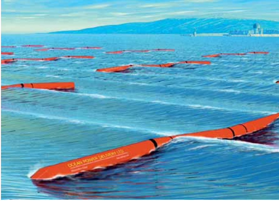
Deniz yılanı olarak da adlandırılan pelamisler, denizlerdeki ve okyanuslardaki yüzey dalgalarının enerjisini emen makinelerdir. Görüldüğü gibi çok büyük bir alana yayılmışlar (Portekiz kıyıları).
