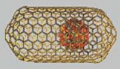
Tüp içine yerleştirilmiş top elektronik anahtar gibi çalışıyor
