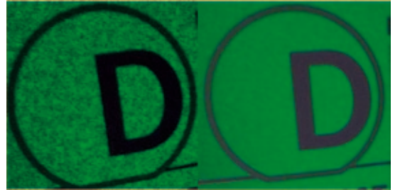
Şekil 4. Lazer kaynağı ile oluşan girişim beneksi ve Dyoptika firmasının girişim beneksi azaltma teknolojinin görüntü kalitesi üzerindeki etkisi (kaynak Dyoptika)
