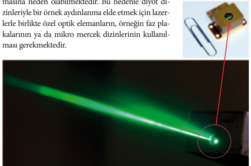
Şekil 2. Sumitomo Electric firmasının ürettiği dünyanın ilk 531nm frekans katlamasız yeşil lazer diyodu (kaynak: Sumitomo)
