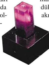
Plastik kaplamasında protein üzerinde lazer uygulanınca bunun fotodöngü durumu değişiyor. Bu durumlar bilgisayar verilerini temsil ediyor.
