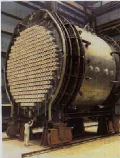
Ağır su ve doğal uranyum kullanan CANDU adı ile anılan basınçlı tüplü nükleer güç santralının reaktör kazanı. Bu reaktör, 600 MW gücünde diğer reaktör tiplerine kıyasla en büyük kor hacmine sahip ticari reaktördür
