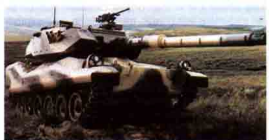
FMC firmasının "hunter-killer" nişan alma sistemli, 105 mm uçaksavar toplu ve otomatik top yükleyicili hafif tankı.
