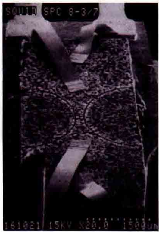
SQUID (Superconducting Quantum Interference Device), örneğin, insan beyninin ürettiği elektrik akımlarınca oluşturulanlar gibi, çok küçük manyetik alanları ölçmede alıcı olarak kullanılabilen bir süperiletkenlik elektroniği devresidir. Fotoğrafta görülen SQUID, süperiletken seramik malzeme ile yapılmıştır.
