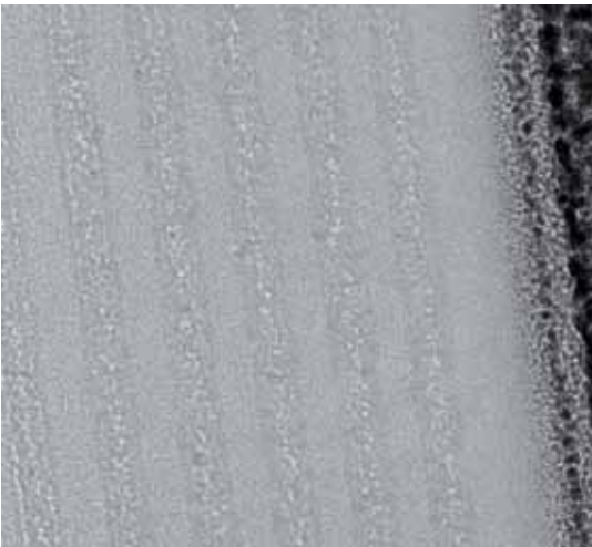
Şekil 6: GÜNAM'da üretilen nanokristallerin geçirimli elektron mikroskop görüntüleri: silisyum karbür malzemesi içinde üretilen silisyum nanokristal bantları
