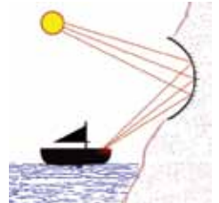
Arkhimedes dev bir çukur ayna kullanarak Roma donanmasının gemilerini yakmıştı. Çukur aynaların, ince kenarlı mercekler gibi, ışınları bir noktaya toplama özelliği vardır. Arkhimedes bu bilimsel kuralı pratiğe uygulamış ve dev bir optik araç yapmıştı.
