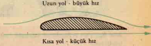
ŞEKİL 3 : Kanat profilindeki hava dolaşımı
