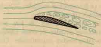
ŞEKİL 6 : Üst hava dolaşımının, fazla büyük hücum açısının etkisinde kopması
