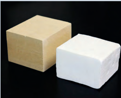
Doğal ahşap (solda) ve süper-serin ahşap (sağda) Görsel: Liangbing Hu, InventWood
