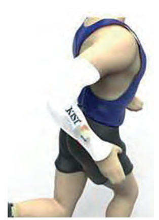
Esnek batarya, üç boyutlu yazıcı teknolojisiyle doğrudan esnek bir kumaşın üzerine de yazdırılabiliyor.
