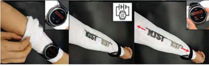
Üretilen esnek batarya giyilirken, çıkarılırken ya da esnetilirken akıllı saatlere kesintisiz güç sağlayabiliyor.
