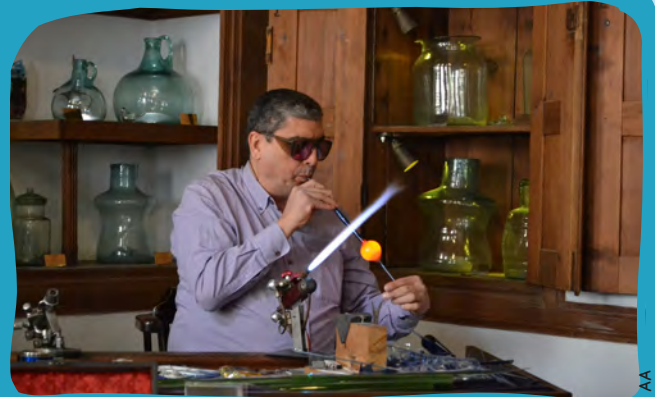
Cam üfleme borusuyla camı şişiren ve bir yandan da şekillendiren cam ustası.
