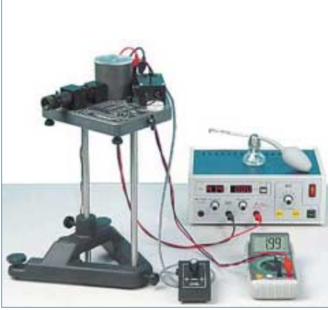
Millikan'ın elektronun elektrik yükünü hesaplamada kullandığı deney düzeneğinin modern bir örneği.
